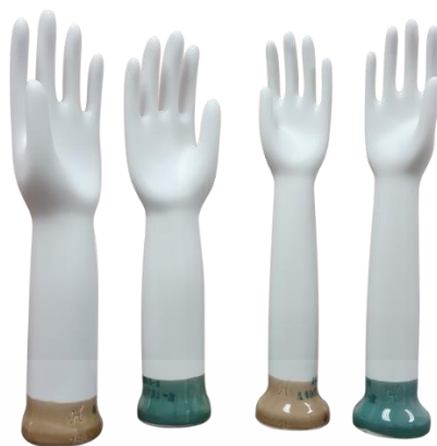
รูปที่ 2.4 ตัวอย่างเบ้ามือเซรามิกสำหรับใช้ผลิตถุงมือยาง [16]
