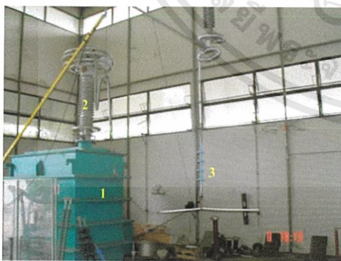
รูปที่ 3 วงจรทดสอบการวาวไฟตามผิวแห้ง
