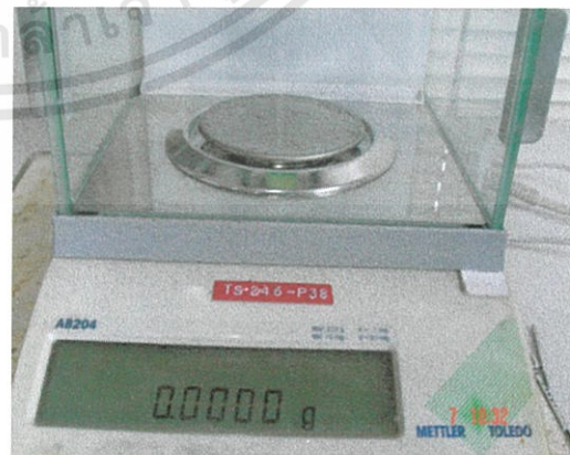
รูปที่ 11 เครื่องชั่งน้ำหนักแบบดิจิทัล ความละเอียดสูง ผลิตภัณฑ์ : METTLER Model : AB 204
