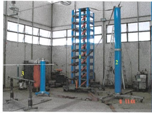
รูปที่ 4 วงจรทดสอบการวาวไฟตามผิวอิมพัลส์วิกฤต
