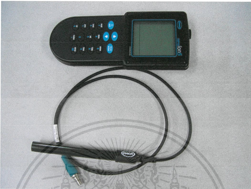
รูปที่ 10 เครื่องมือวัดความนำไฟฟ้าและอุณหภูมิของน้ำ ผลิตภัณฑ์ : HACH Model : session 5
