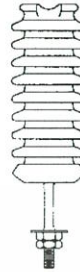
ลูกถ้วยไลน์โพลท์ไทพ์ แบบ 57-2 LINE POST TYPE INSULATOR CLASS 57-2 MAT.No. 0301001
