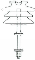
ลูกถ้วยก้านตรง 22 กิโลโวลต์ แบบ 56-2 PIN TYPE INSULATOR, 22 kV CLASS 56-2 MAT.No. 0300001
