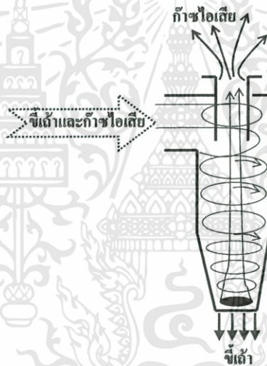
รูปที่ 4.15 การทำงานของไซโคลน
