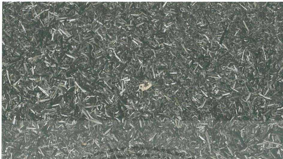
รูปที่ ค.12 ขี้เถ้าที่เกิดจากการเผาไหม้ในกรณีที่ดินคกรูปตัววีคว่า จำนวน 3 คู่, ที่ค่าเปอร์เซ็นต์ อากาศส่วนเกิน 70%
