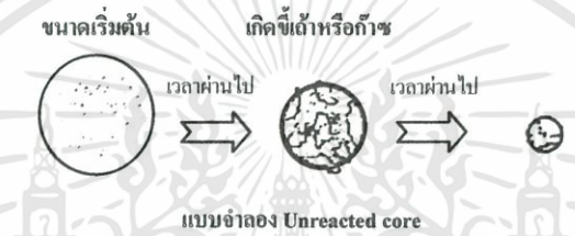
รูปที่ 3.3 แบบจำลองการเผาไหม้เชื้อเพลิงแข็ง
