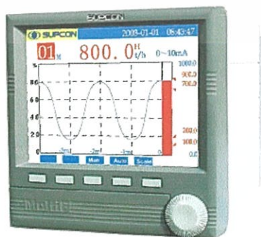
รูปที่ 4.12 เครื่องบันทึกข้อมูล (data logger)
