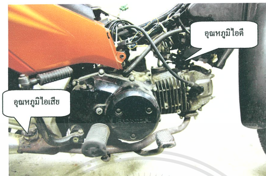
รูปที่ 3.27 ตำแหน่งในการวัดอุณหภูมิไอดีและไอเสีย
