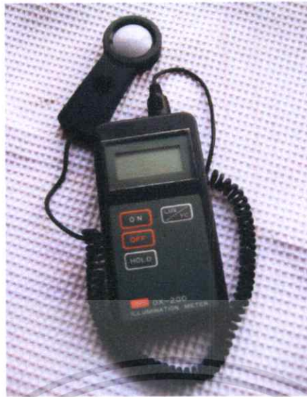
รูปที่ 2.2 เครื่องวัดปริมาณของการส่องสว่าง ฟุต-แคนเดิลมิเตอร์ และ ลักซ์มิเตอร์
