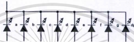
รูปแสดง โครงสร้างภายในของ 7-Segment ชนิดขาพร้อมแบบลบ (Common Cathode)
