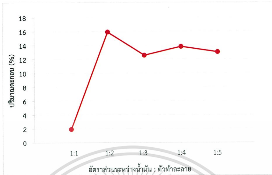
รูปที่ 4.2 ปริมาณตะกอนกับอัตราส่วนระหว่างน้ำมันหล่อลื่นใช้แล้วต่อตัวทำละลายเอทิลโพรพาโนเอท (Ethyl propanoate)
