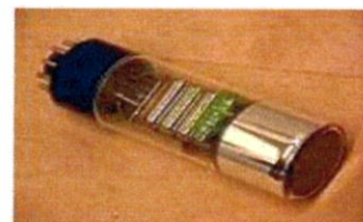
รูปที่ 2.14 (ซ้าย)ภาพตัดขวางของหลอด PMT (ขวา) ลักษณะหลอด PMT [13]
