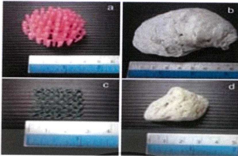
รูปที่ 2.3 ชนิดของตัวกลางที่ใช้ในการทดลอง ชนิดa. ไบโอบอล ชนิดb.เปลือกหอยนางรม ชนิดc. แผ่นอวนไนลอนชนิดทอไม่มีปม และชนิดd. หินภูเขาไฟ
