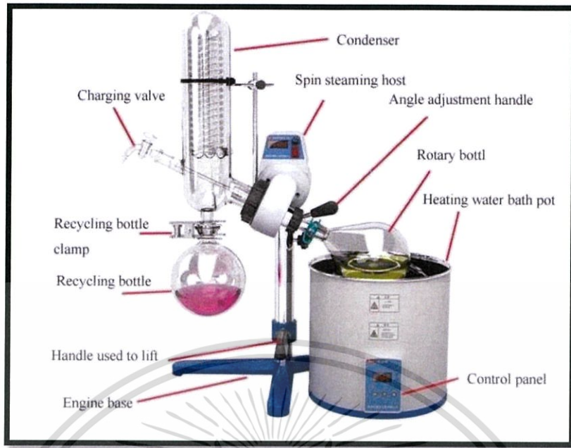
รูปที่ 2.4 แสดงส่วนประกอบต่างๆของเครื่องระเหยสุญญากาศแบบหมุน
