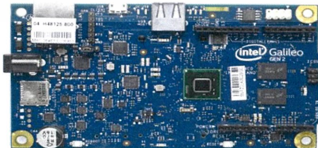
รูปที่ 2.1 ไมโครคอนโทรลเลอร์ Intel Galileo Gen 2
