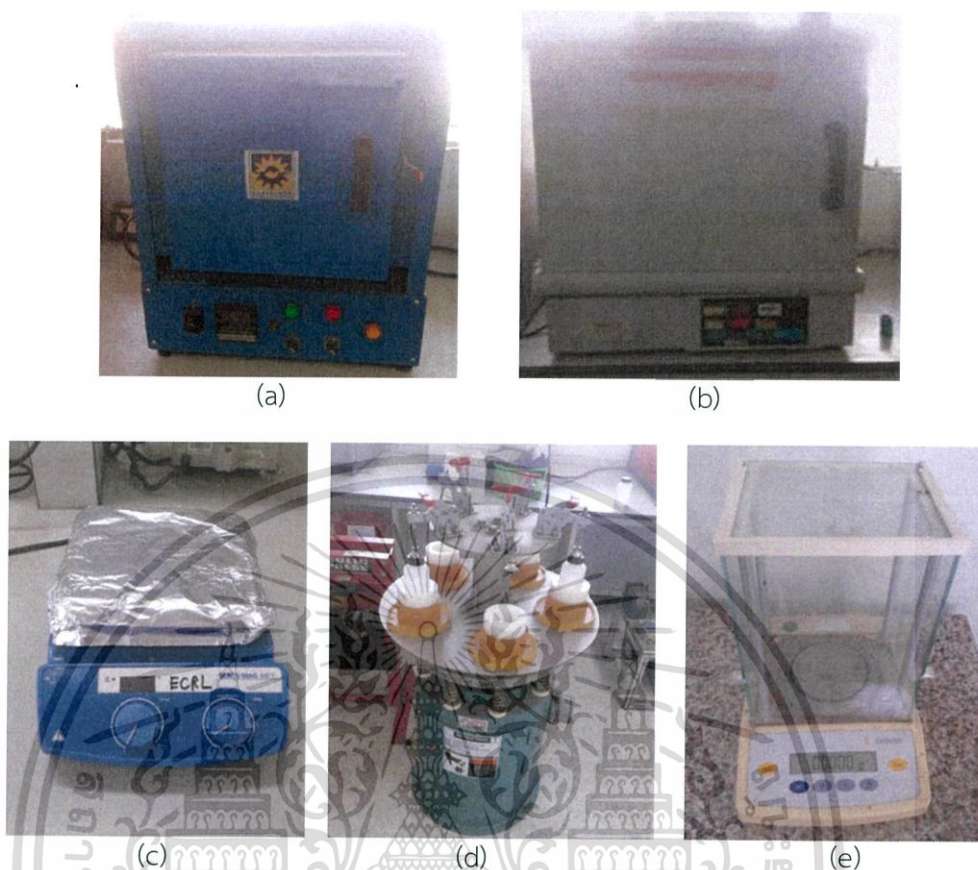
รูปที่ 3.2 แสดงอุปกรณ์ที่ใช้ในการทดลอง (a) เตาเผาสาร (b) เตาอบความร้อน (c) เครื่องกวนผสมแบบแม่เหล็กเหนียวนำพร้อมแท่งแม่เหล็ก (d) เครื่องบดย่อยแบบกระแทก และ (e) เครื่องชั่งละเอียด 4 ตำแหน่ง
