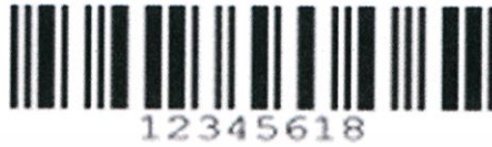
รูปที่ 2.19 แสดงตัวอย่างบาร์โค้ดแบบ Interleaved 2 of 5 (ที่มา http://www.rightsoftcorp.com/UserFiles/Image/rightsoft-barcode-interleave%202%20of%205.jpg )
