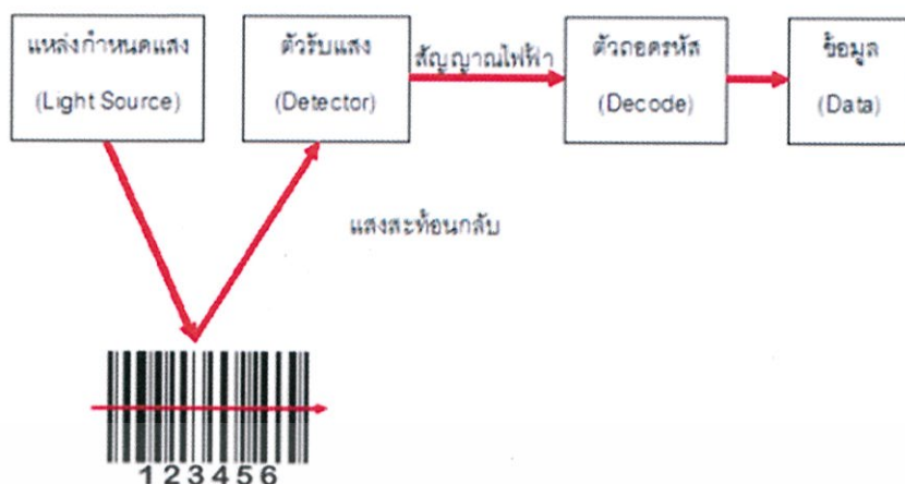
รูปที่ 2.29 แสดงหลักการทำงานของเครื่องอ่านบาร์โค้ด (ที่มา http://riverplusblog.files.wordpress.com/2011/06/untitled-4.jpg?w=490 )
