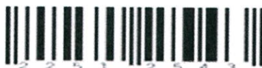
รูปที่ 2.16 แสดงตัวอย่างบาร์โค้ดแบบ EAN-8
