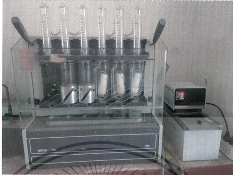
ภาพผนวก จ 3 เครื่องวิเคราะห์ไขมัน ยี่ห้อ BUCHI รุ่น 810
