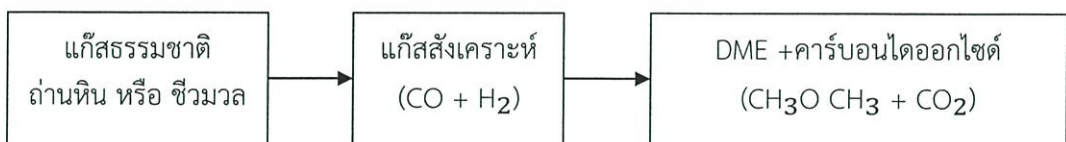
รูปที่ 2.4 กระบวนการผลิตไดเมทิลอีเทอร์แบบทางอ้อม (Indirect DME Synthesis) หรือ กระบวนการ ดีไฮเดรชันของเมทานอล (Methanol Dehydration)
