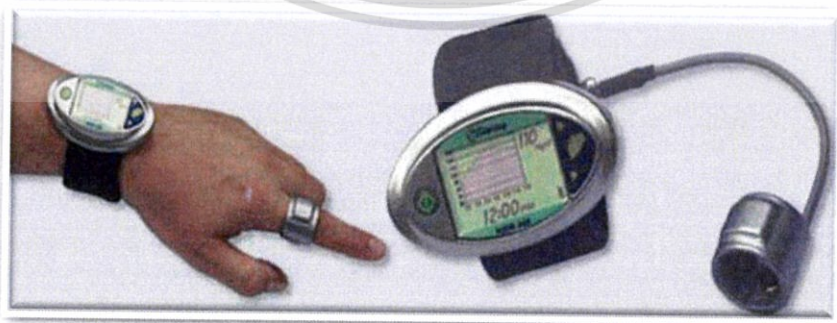
รูปที่ 2.7 เครื่องวัดระดับน้ำตาลในเลือดแบบไม่เจาะเลือดโดยใช้เทคนิค Occlusion Spectroscopy ( http://www.medgadget.com/2007/06/noninvasive_glucometer_from_orsense_approved_in_europe.html )
