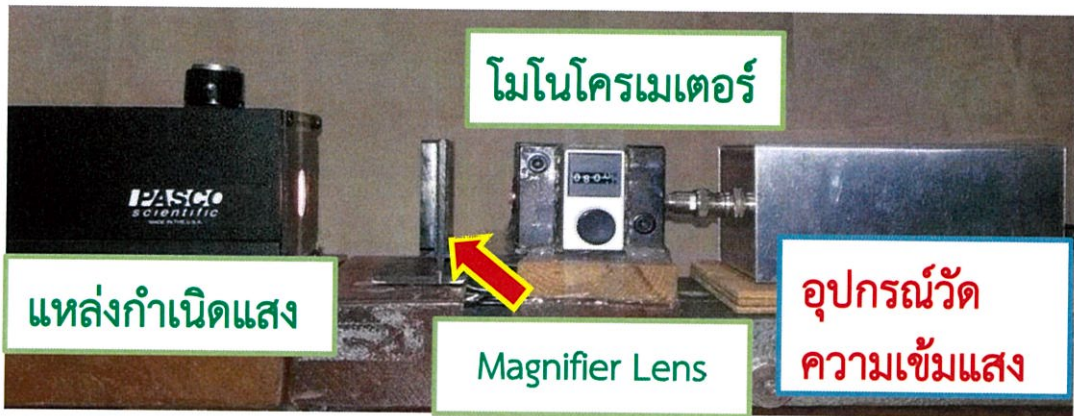
รูปที่ 3.21(b) ภาพขยายแสดงส่วนทางแสงหลัก
