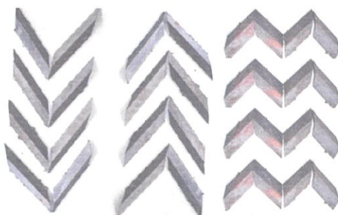
รูปที่ 2.14 การติดตั้งครีบริบที่ใช้ในทดลอง
