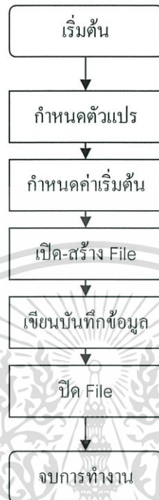
รูปที่3.11 โฟลว์ชาร์ตขั้นตอนการเขียน โปรแกรมควบคุมการเขียนข้อมูลลง SD Card
