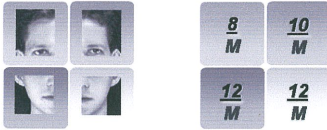
รูปที่ 2.10 แสดงตัวอย่างการเพิ่มค่าถ่วงน้ำหนักในแต่ละส่วนของภาพใบหน้าย่อย
