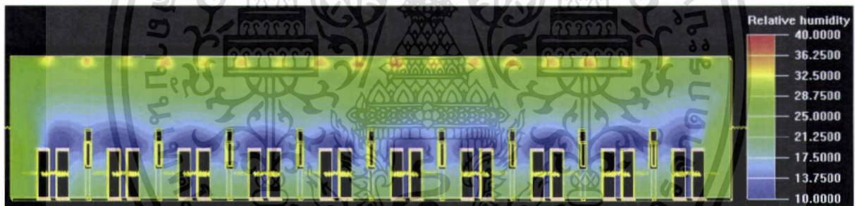
รูปที่ 5.40 การกระจายตัวของความชื้นสัมพัทธ์ที่อัตราการระบายอากาศเท่ากับ 53 ACH จากการจ่ายอากาศที่ระดับ 11.5 ft ด้วยหัวจ่ายแบบท่อจำนวน 180 หัวจ่าย ( z = 5.875 )
