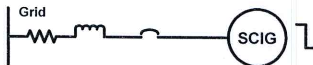
รูปที่ 4.2 ระบบที่ใช้ในการทดสอบการเปลี่ยนแปลงแรงบิดทางกลที่โรเตอร์แบบทันทีทันใด
