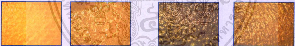
(a) การทดสอบที่ 0 รอบ (b) การทดสอบที่ 50,000 รอบ (c) การทดสอบที่ 100,000 รอบ (d) การทดสอบที่ 200,000 รอบ
