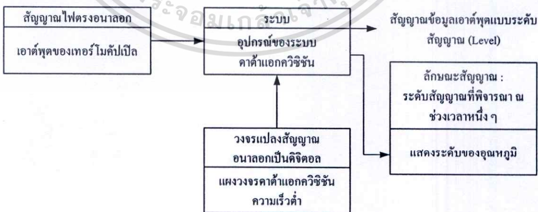
รูปที่ 2.4 กระบวนการทำงานกับสัญญาณไฟตรงอนาลอกในระบบค่าตัวแยกควิซิชัน
