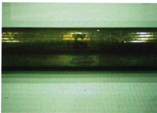
(ค) วัสดุเป็นเหล็กชุบทองแดง 250 \mu\text{m} No.7
