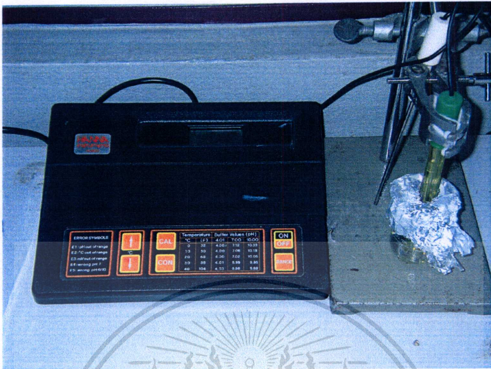
รูปที่ 3.19 เครื่อง pH meter แบบหิ้ว HANNA HI 8521
