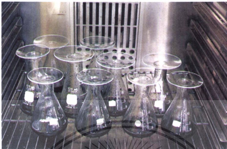
ภาพผนวก ก-7 ภาพแสดงหลังจากไฮโดรไลสที่อุณหภูมิ 105 \pm 1 องศาเซลเซียส เป็นเวลา 16 ชั่วโมง
