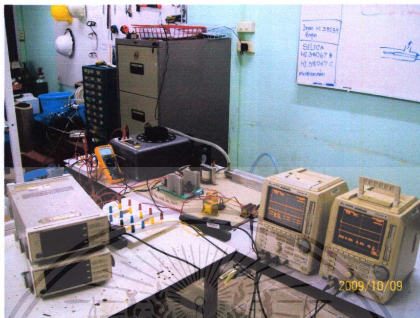
รูปที่ 5.2 แสดงการวัดกำลังไฟฟ้าทางดำนอินพุทและเอาต์พุทของคอนเวอร์เตอร์
