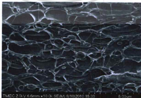
รูปที่ 4.7 การกระจายตัวของแป้งในฟิล์ม LDPE/LLDPE/TPS ที่ปริมาณแป้ง 70 phr
