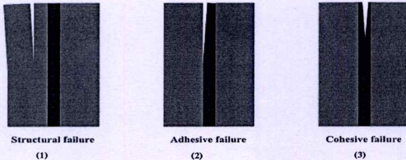
รูปที่ 4.10 การแตกหักหรือฉีกขาดของกาวกับไม้
