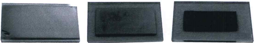
รูปที่ 4.1 แสดงภาพถ่ายของฟิล์มบางของ Cu, ของสารกึ่งตัวนำ Sb_2Te_3 และของสารกึ่งตัวนำ CdTe ซึ่งถูกเคลือบลงบนแผ่นฐานรองรับที่เป็นกระจกสไลด์ตามลำดับที่เตรียมได้โดยวิธีการระเหยสารเคมีด้วยความร้อนในระบบสุญญากาศ โดยให้อุณหภูมิแก่แผ่นฐานรองรับที่เป็นกระจกสไลด์ในกรณีที่เคลือบฟิล์มบางของ Cu เท่ากับ 150 องศาเซลเซียสและฟิล์มบางของสารกึ่งตัวนำ Sb_2Te_3 เท่ากับ 100 องศาเซลเซียส แต่สำหรับในกรณีของฟิล์มบางของสารกึ่งตัวนำ CdTe นั้นจะไม่มีกรให้อุณหภูมิแก่แผ่นฐานรองรับที่เป็นกระจกสไลด์
