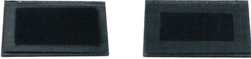
รูปที่ 4.2 แสดงภาพถ่ายของฟิล์มบางของสารกึ่งตัวนำ Sb_2Te_3 และของสารกึ่งตัวนำ CdTe ซึ่งเคลือบลงบนฟิล์มบางของ Cu ตามลำดับที่เตรียมได้โดยวิธีการระเหยสารเคมีด้วยความร้อนในระบบสุญญากาศ โดยให้อุณหภูมิแก่แผ่นฐานรองรับที่เป็นกระจกสไลด์ เท่ากับ 100 องศาเซลเซียส
