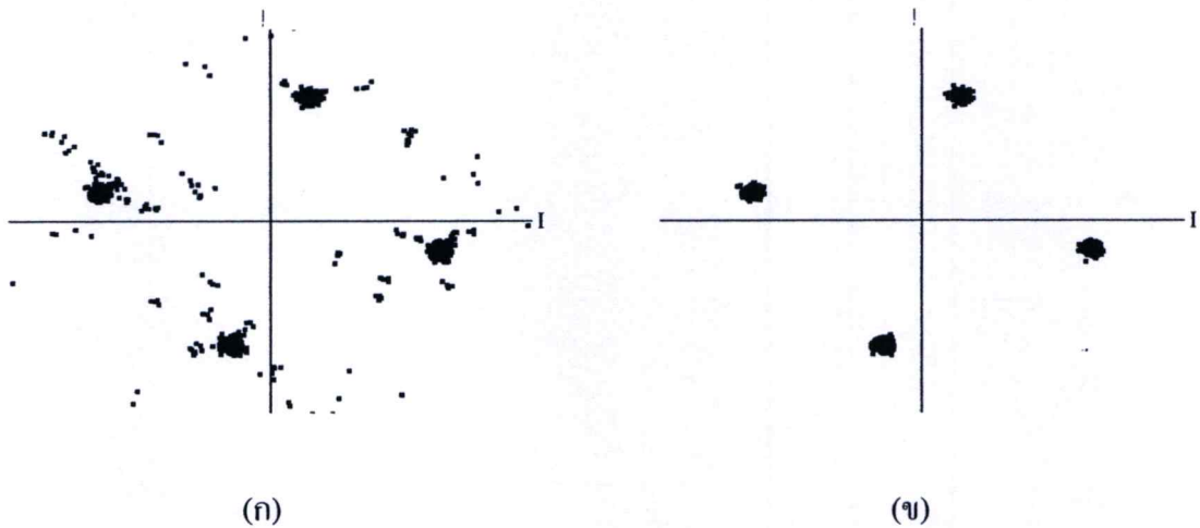
รูปที่ 3.18 แผนภาพกลุ่มดาว (constellation diagram) ของสายอากาศแวลำดับปรับตัวด้วยอัลกอริทึม CMA โดยใช้การปรับลำคลื่นเป็นตัวเริ่มต้น หลังการทำซ้ำครั้งที่ (ก) 0 (ข) 500
