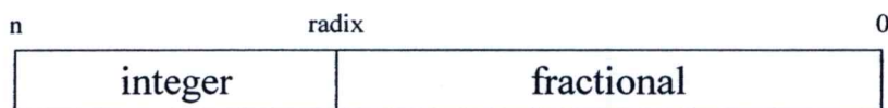
รูปที่ 5.2 โครงสร้างการแสดงผลตัวเลขแบบจุดตรึง
