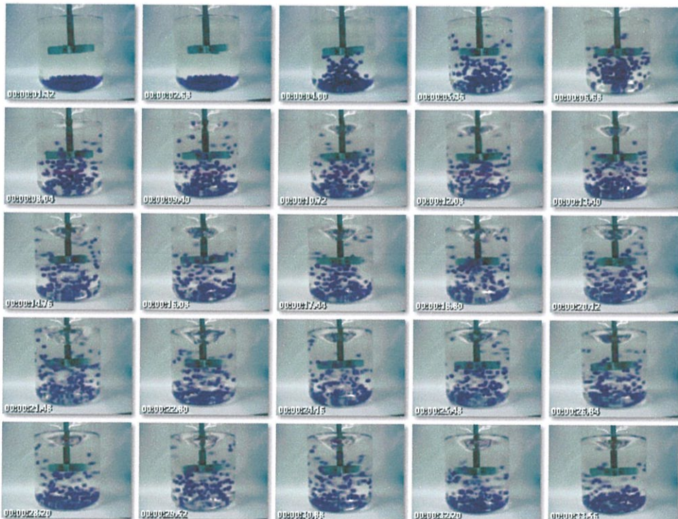
รูปที่ 6.37 สัญญาณ Chua แบบ Single Scroll L_{eq} = 1.80 H (เม็ดพลาสติก)
