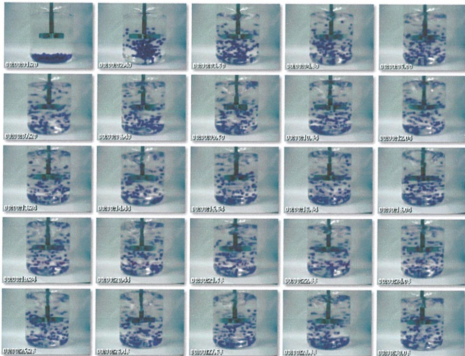
รูปที่ 6.34 สัญญาณรูปไซน์ 5 V_{p-p} ความถี่ 1 Hz (เม็ดพลาสติก)
