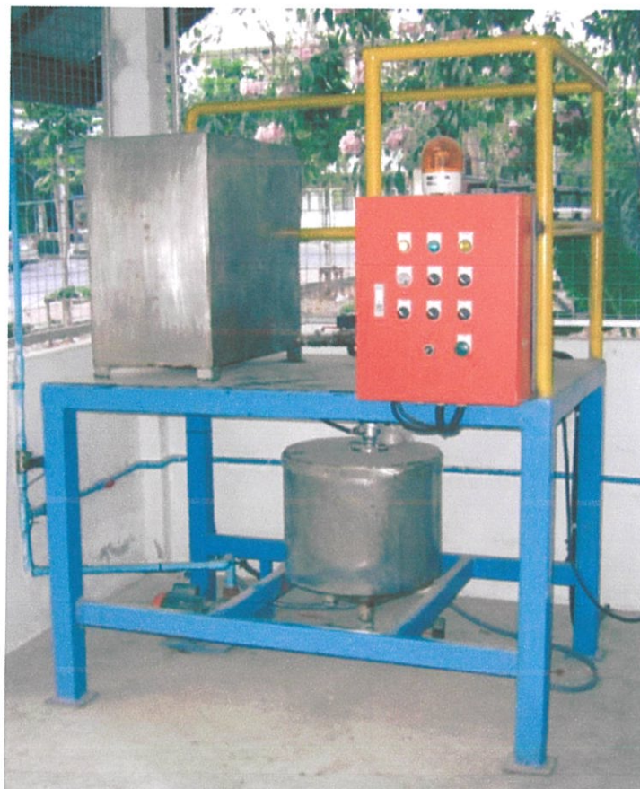
รูปที่ 5.8 เครื่องบำบัดกลิ่นขยะอัตโนมัติ
