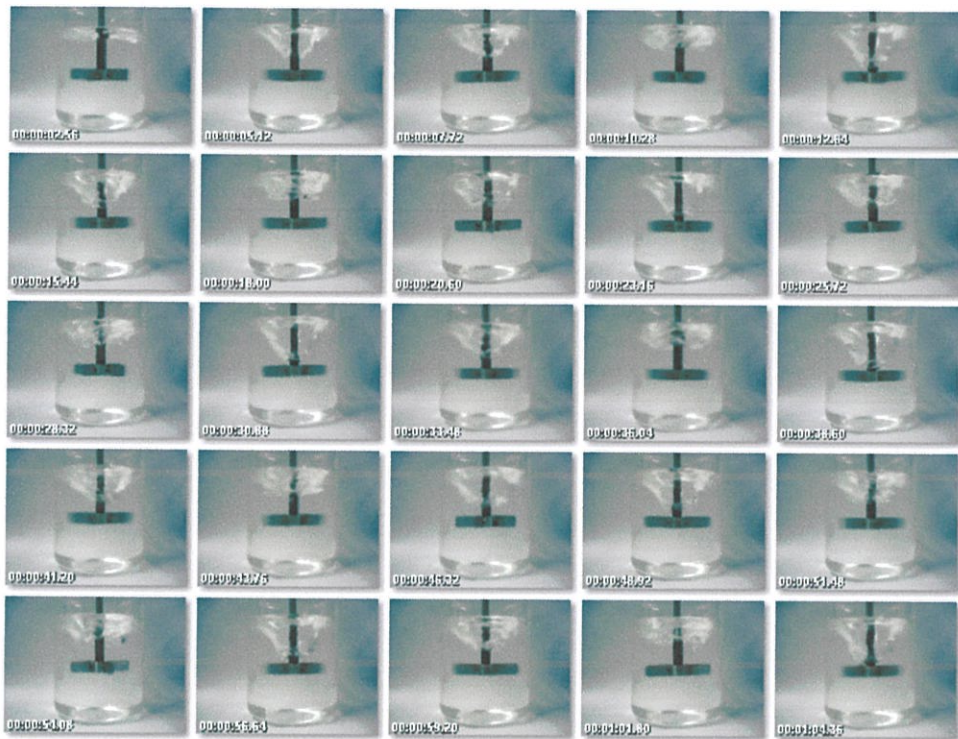
รูปที่ 6.29 สัญญาณรูปไซน์ 5 V_{p-p} ความถี่ 1 Hz (ไม่มีสิ่งปนเปื้อน)
