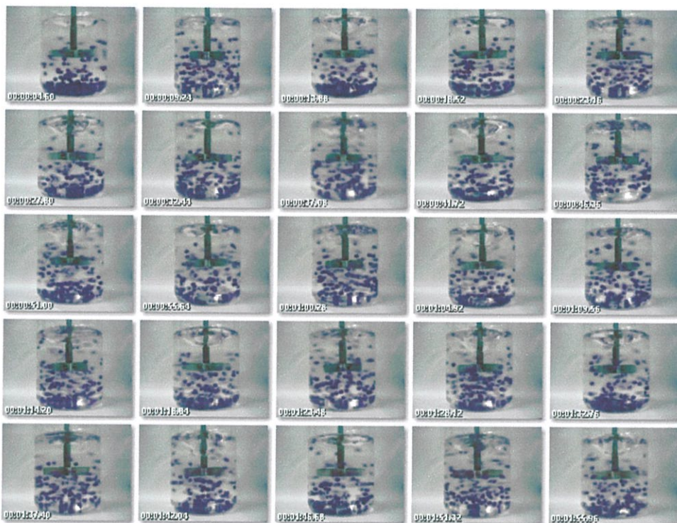
รูปที่ 6.41 สัญญาณ Chua แบบ Double Scroll L_{eq} = 5.94 H (เม็ดพลาสติก)
