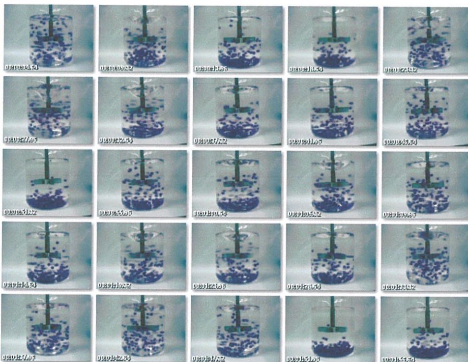
รูปที่ 6.42 สัญญาณ Chua แบบ Double Scroll L_{eq} = 8.46 H (เม็ดพลาสติก)
