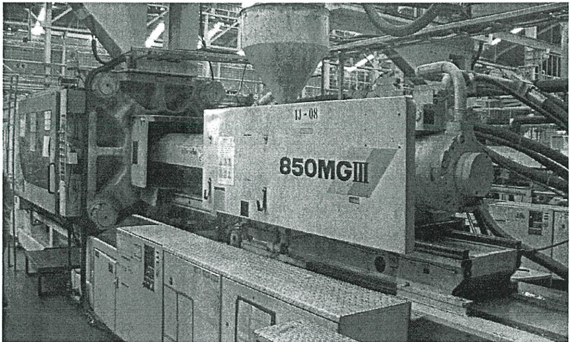
รูปที่ 4.7 เครื่องฉีดพลาสติกขนาด 850 tons
