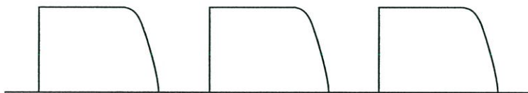
(ค) ความเสียหายอุปกรณ์แบบสม่ำเสมอ และมีเวลาเตือนการเกิดความเสียหาย
