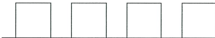
(ง) ความเสียหายอุปกรณ์แบบสม่ำเสมอ แต่ไม่มีเวลาเตือนการเกิดความเสียหาย
