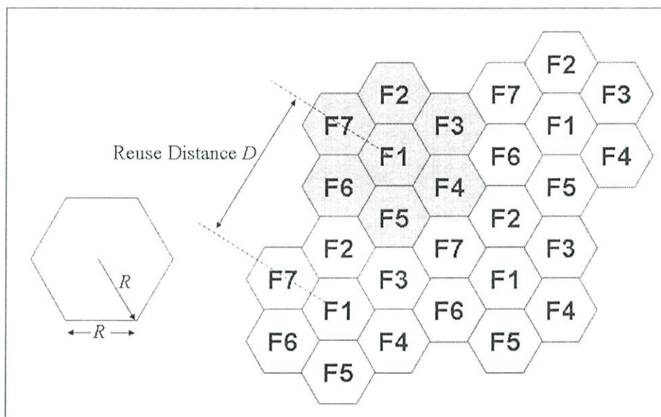
รูปที่ 2.8 แสดงการใช้ความถี่ซ้ำของเครือข่ายเซลลูล่า
