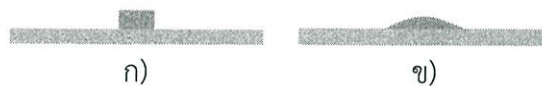
รูปที่ 3.17 ลักษณะชิ้นงาน ก) ก่อนผ่านกระบวนการทดสอบการแผ่กระจาย ข) หลังจากผ่านกระบวนการทดสอบการแผ่กระจาย
