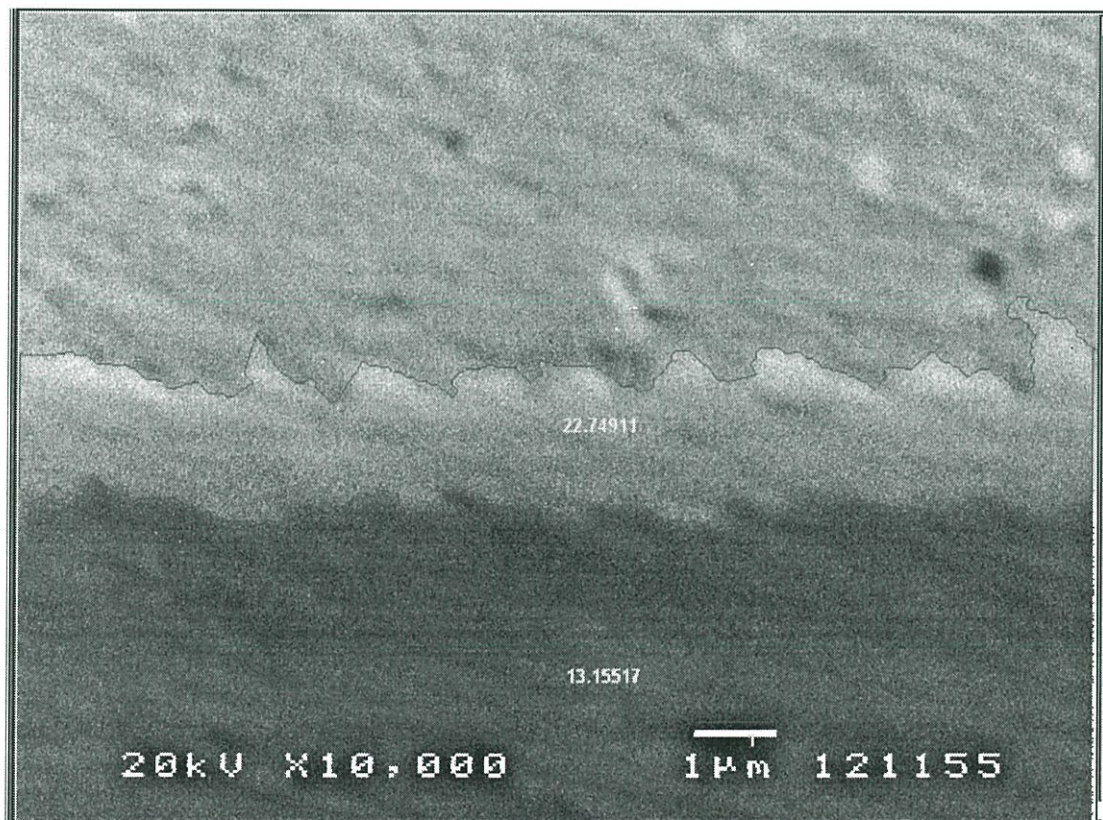
ภาพที่ ซ.14 ความหนาของชั้นสารประกอบบริเวณรอยต่อของโลหะบัดกรี SCNG+0.05Bi-0.05Sb
