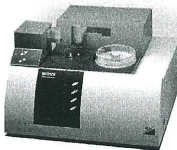
รูปที่ 3.13 Differential scanning calorimeter ของ NETZSCH รุ่น DSC 204 F1
