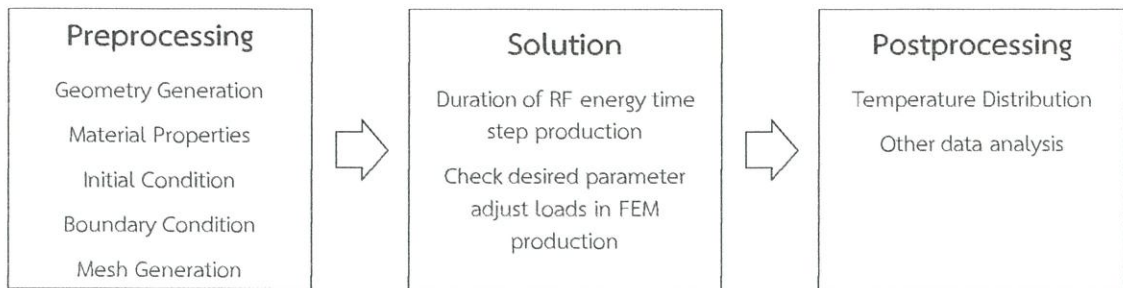
รูปที่ 3.3 กระบวนการวิเคราะห์วิธีไฟไนต์เอลิเมนต์ด้วย COMSOL Multiphysics
