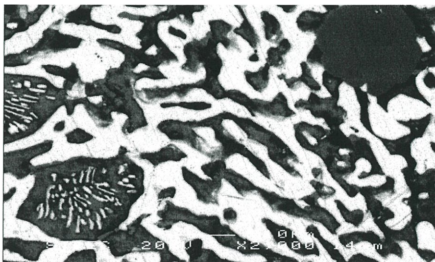
ภาพที่ ง.42 โครงสร้างจุลภาคของโลหะบัดกรี Sn58Bi-1.0Ni-0.1Ag ที่กำลังขยาย 2,000 เท่า
