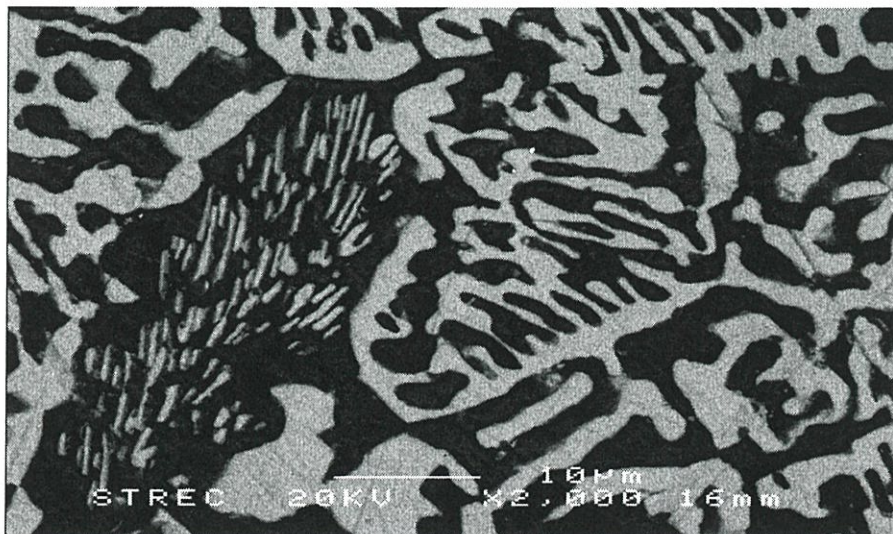
ภาพที่ ง.36 โครงสร้างจุลภาคของโลหะบัดกรี Sn58Bi-0.05Ni-0.1Ag ที่กำลังขยาย 2,000 เท่า
