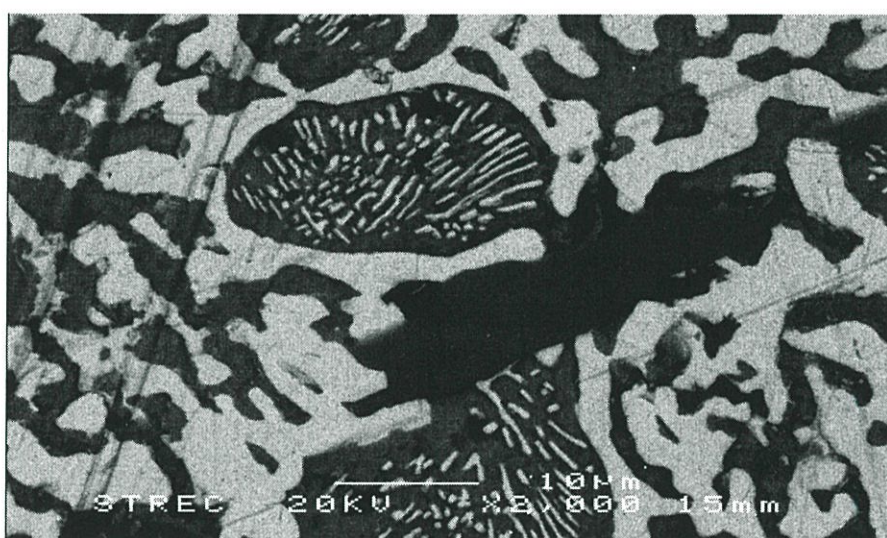
ภาพที่ ง.41 โครงสร้างจุลภาคของโลหะบัดกรี Sn58Bi-1.0Ni-0.05Ag ที่กำลังขยาย 2,000 เท่า
