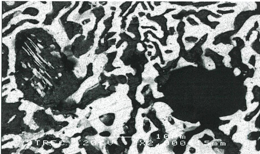
ภาพที่ ง.34 โครงสร้างจุลภาคของโลหะบัดกรี Sn58Bi-1.0Ni-0.1In ที่กำลังขยาย 2,000 เท่า
