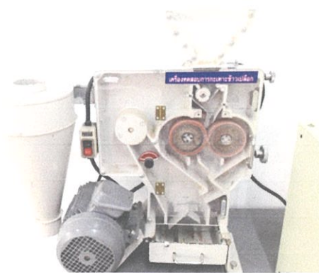
ภาพที่ 3.4 เครื่องกะเทาะเปลือก SATAKE HUSK TESTER รุ่น THU
