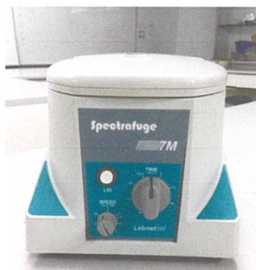
ภาพที่ 3.7 เครื่องปั่นแยกสาร (Spectrafuge)
