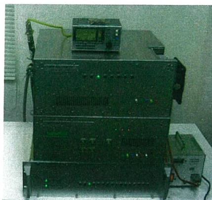
รูปที่ 3.2 ชุดอุปกรณ์เครื่องส่งเครื่องรับภายในระบบไอโอโนโซนดท์
