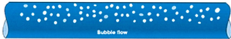
รูปที่ 3.1 Bubbly flow, IHS GlobalSpec (2011)
