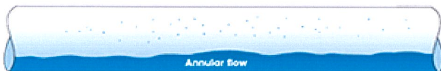
รูปที่ 3.6 Annular flow, IHS GlobalSpec (2011)
