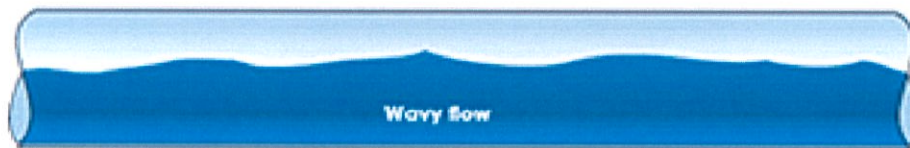
รูปที่ 3.4 Wavy flow, IHS GlobalSpec (2011)
