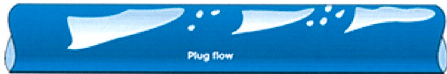
รูปที่ 3.2 Plug flow, IHS GlobalSpec (2011)
