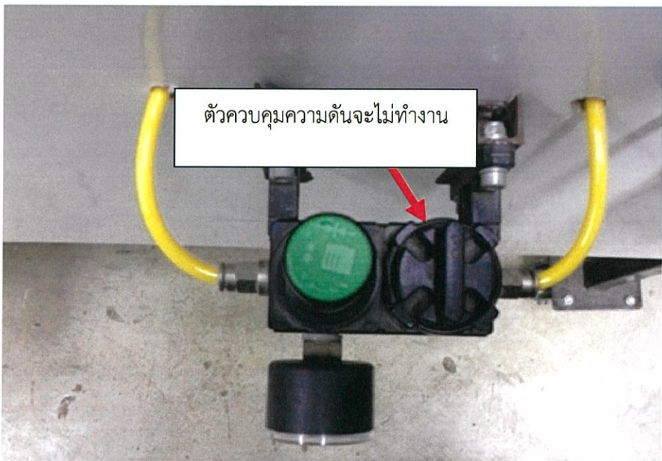
รูปที่ 4.22 แสดงการใช้งานตัวควบคุมความดัน
