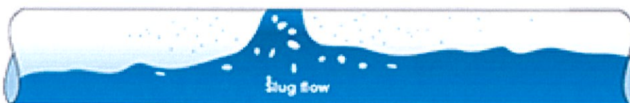
รูปที่ 3.5 Slug flow, IHS GlobalSpec (2011)
