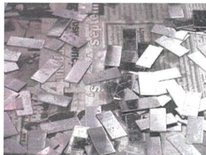
รูปที่ 4.7 ชิ้นงานทดสอบจากการตัดด้วยแม่พิมพ์
