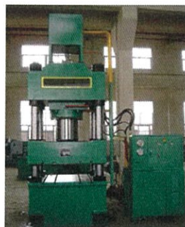
รูปที่ 4.3 เครื่องไฮดรอลิคเพรส ขนาด 60 ตัน
