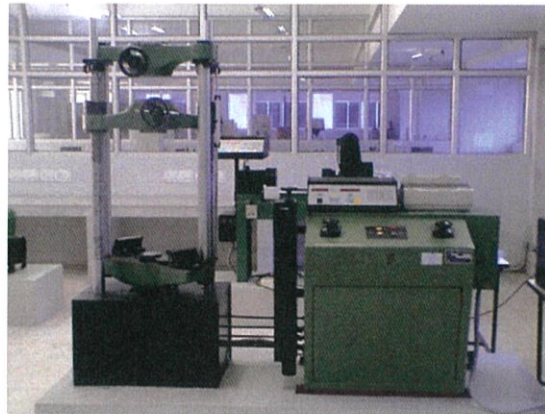
รูปที่ 4.4 เครื่องทดสอบแรงดึงแบบ Screw-driven machine ขนาด 10 ตัน
