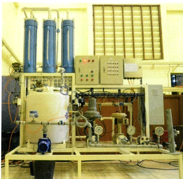
รูปที่ 4.1 พลาเน็ตโมเดลในการควบคุมระดับที่ใช้ในการทดลอง
