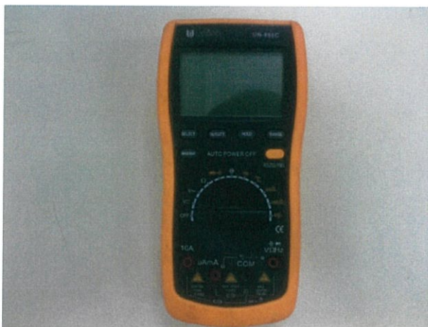
รูปที่ 5.6 รูปแสดงมัลติมิเตอร์รุ่น UNION UN-860C
