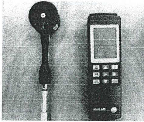
รูปที่ 4.12 เครื่องวัดความเร็วของอากาศ (Vane-type Anemometer), TESTO 445
