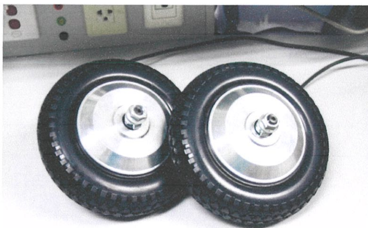
รูปที่ 3.8 BLDC Motor HUB Model: PW-12H Wheelchair Hub Motor (brush/gear) [1]
