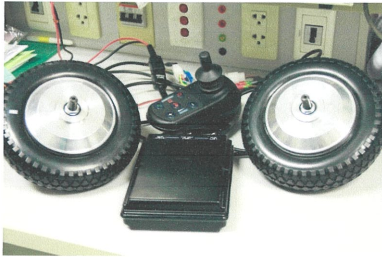
รูปที่ 3.10 จอยสติ๊กและคอนโทรลเลอร์ IM-50B กับ BLDC Motor HUB Model: PW-12H [1]
