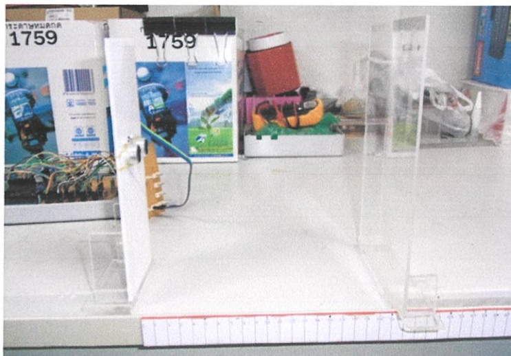
รูปที่ 5.1 การทดสอบเพื่อศึกษาความคลาดเคลื่อนของเซนเซอร์อัลตราโซนิก HC-SR04
