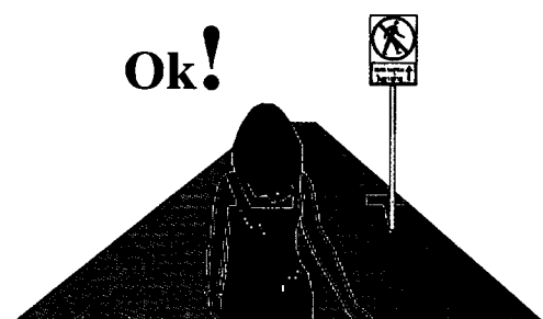
การติดตั้งป้ายห้ามคนผ่านแบบใหม่ โดยติดตั้งตั้งฉากกับทางเดินรถ
