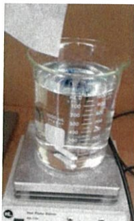
รูปที่ 3.1 แสดงการผสมสีย้อมเมธิลีนบลู 2.00 มิลลิกรัม ผสมกับน้ำ DI 1 ลิตร
