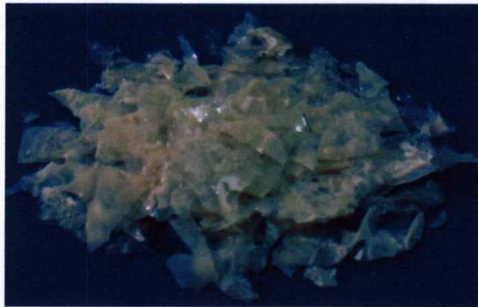
ภาพที่ 4.16 ไซโลกลูแคนที่ผ่านการทำแห้งด้วยไมโครเวฟกำลังไฟฟ้า 600 วัตต์นาน 6 นาที
