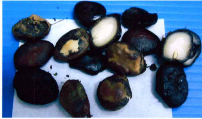
ภาพที่ 4.5 ภาพเมล็ดมะขามที่ต้มในสารละลายโซเดียมไฮดรอกไซด์ 0.5 % (นน./นน.) อุณหภูมิ 80 °ซ นาน 45 นาทีแล้วทำแห้งด้วยไมโครเวฟกำลังไฟฟ้า 600 วัตต์ นาน 10 นาที
