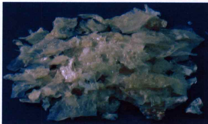
ภาพที่ 4.17 ไซโลกลูแคนที่ผ่านการทำแห้งด้วยไมโครเวฟกำลังไฟฟ้า 900 วัตต์นาน 4 นาที
