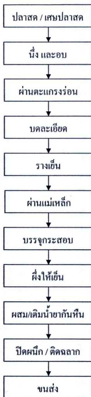
ภาพที่ 2.1 แผนภูมิกระบวนการผลิตผลิตภัณฑ์ปลาป่น
